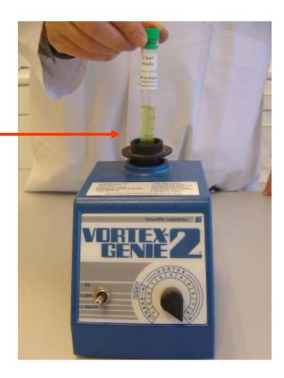
CAP THE TUBE AND SHAKE VIGOROUSLY TO DISSOLVE THE ALGINATE MATRIX
